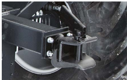
Zadní homologovaný tažný hák. Rear approved towing hook.
