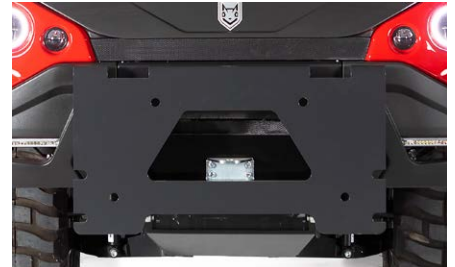
Přední deska pro upevnění nářadí se spojkou skupiny 3 DIN B. Front tool fixing plate with DIN B group 3 coupling
