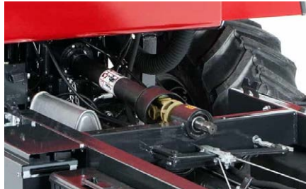
Centrální vývodový hřídel 540 ot/min s výstupem nad převodovkou, s nezávislou hydraulickou spojkou a elektrohydraulickým ovládáním. Central 540 rpm power take-off with output above gearbox, independent hydraulic clutch, and electro-hydraulic control
