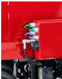
Třípákový hydraulický rozdělovač s regulátorem průtoku a rychlospojkami za a před kabinou. 3-Lever hydraulic distributor with flow regulator and quick couplings behind and in front of the cab
