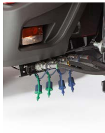
Třípákový hydraulický rozdělovač s regulátorem průtoku a rychlospojkami za a před kabinou. 3-Lever hydraulic distributor with flow regulator and quick couplings behind and in front of the cab
