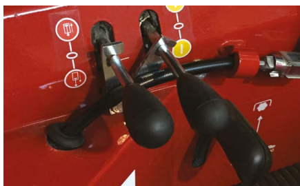
2pákový hydraulický rozdělovač se 3 rychlospojkami za sedadlem. 2-Lever hydraulic distributor with 3 quick couplings behind the seat.
