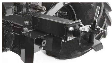
Závěs ojí pro brzděné přívěsy do 14000 kg Drawbar hitch for braked trailers up to 14000 kg
