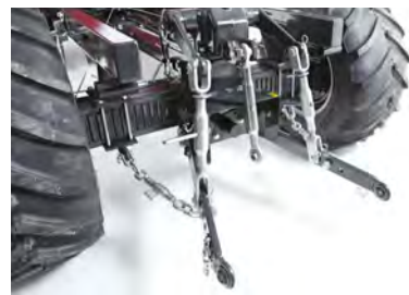
Zadní 3bodový závěs Rear 3-point linkage
