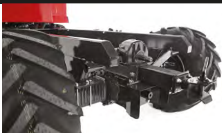
Zadní nezávislý vývodový hřídel Rear independent pto
