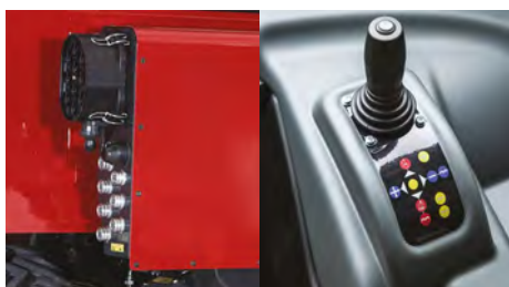
Hydraulické verze s vývody před/zadní kabinou Hydraulic versions with outlets in front of/rear cab
