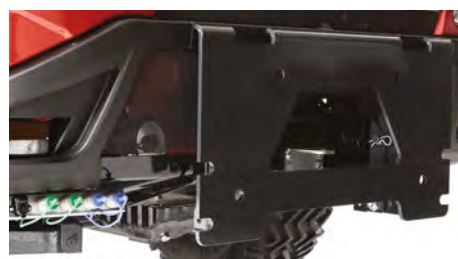
Přední deska nosiče nástrojů Front tool-carrier plate
